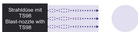
Abb. 3: Das Strahlbild beim Wirbelvorsatz TS98 ist über den ganzen Querschnitt gleich und gewährleistet so eine schonende und zügige Reinigung. Der Wirbelvorsatz TS98 kann auf alle herkömmlichen Sandstrahldüsen mit einem zylindrischen Aussendurchmesser von 25 bis 35 mm montiert werden.
